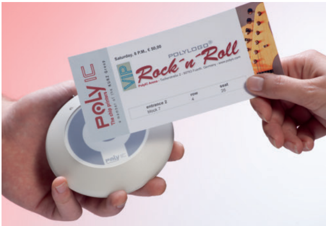
Bild 4. Automatischen Einlass gewähren funktaktivierbare Eintrittskarten (Smart Ticket)
