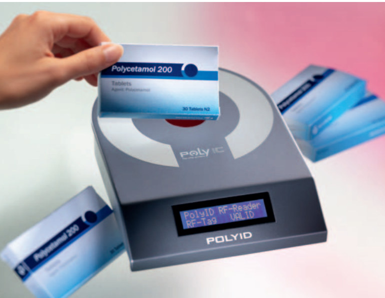
Bild 6. Echtheitsprüfung bei Arzneimitteln durch integrierte RFID Tags in der Verpackung
