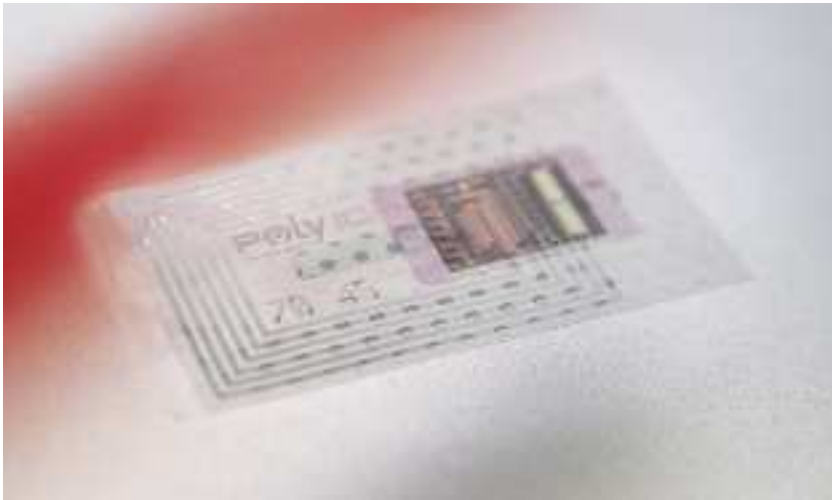
Abbildung 1: Muster eines PolyID® Tags: erster gedruckter polymerer RFID-Tag (13,56 MHz)
